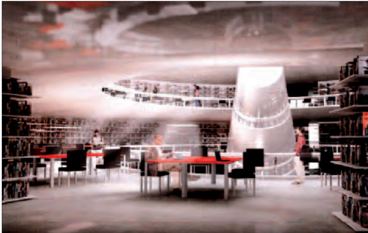
Μία διαφώτιστη κατασκευή θα διαχέει ελεγχόμενα το φυσικό φως στους χώρους ανάγνωσης, ενώ ένας ηλιοστάτης θα κατευθύνει κατακόρυφα μία δέσμη φωτός πάνω στην ανακλαστική επιφάνεια του κώνου που διατρέχει στο κέντρο όλο το εσωτερικό αίθριο.
